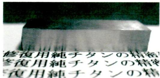
図9 ポリ尿素樹脂ボンド軸付き砥石による研磨面性状
