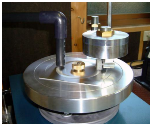
図2 テーバー式摩耗試験式研削試験機概略
